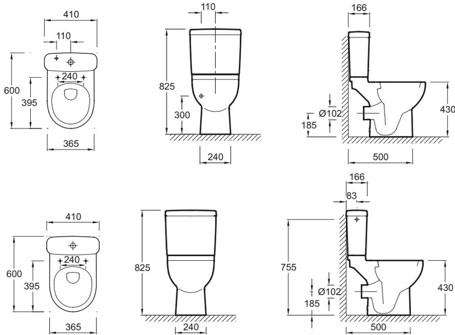
Descriptif CCTP : Cuvette au sol, sortie horizontale. 18557K. Collection : ODÉON UP. DIMENSIONS : 60 x 36,50 cm. POIDS : 26,4 kg. MATÉRIAU : Céramique. TYPE D'INSTALLATION : Au sol. NORMES ET RÉGLEMENTATIONS : NF. CONSOMMATION D'EAU : Standard 3/6 L. HAUTEUR : Confort. TYPE DE BRIDE : Fermée.
