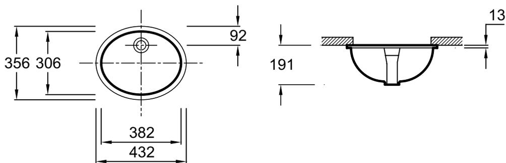
Descriptif CCTP : Vasque à encastrer par-dessous 43 cm. 2209. Collection : CAXTON. DIMENSIONS : 43,20 x 35,60 cm. POIDS : 7,7 kg. MATÉRIAU : Céramique. TYPE D'INSTALLATION : Encastré par-dessous. PERCEMENT ROBINETTERIE : Sans. TROP-PLEIN : Avec.
