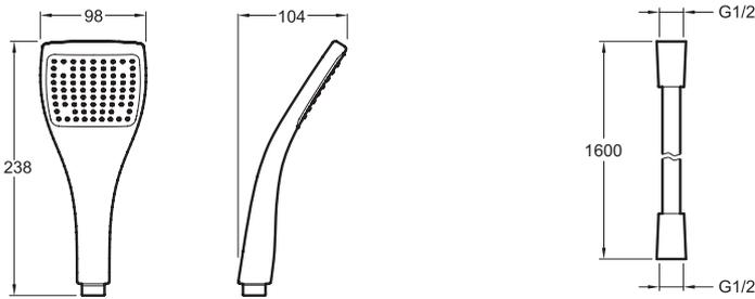
Descriptif CCTP : Douchette à main avec flexible. CE98232. Collection : ÉO. POIDS : 1 kg. MATÉRIAU : Métal. TYPE D'ACCESSOIRE : DOUCHETTE A MAIN. Combiné douche comprenant douchette à main EO Large (E3877-CP) et flexible (E75206-CP).. 77 buses. système anti-calcaire.
