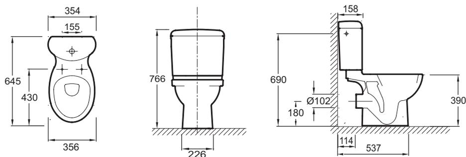
Descriptif CCTP : Pack WC au sol, sortie horizontale. E0379L. Collection : PATIO. DIMENSIONS : 64,50 x 35,60 cm. POIDS : 36,6 kg. MATÉRIAU : Céramique. TYPE D'INSTALLATION : Au sol. CONSOMMATION D'EAU : Standard 3/6 L. HAUTEUR : Standard. TYPE DE BRIDE : Ouverte (traditionnelle). ALIMENTATION : Latérale. TYPE D'ABATTANT : Standard. ABATTANT : à descente progressive et déclinable. MATÉRIAU DE L'ABATTANT : Thermodur. CHARNIÈRES : Métal.
