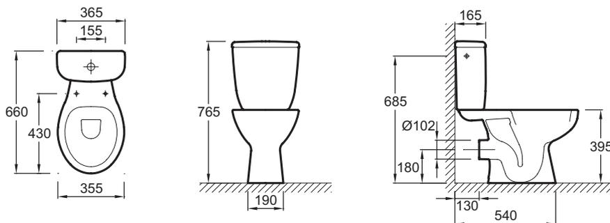
Descriptif CCTP : Pack WC au sol, sortie horizontale. E0383MA0. Collection : BRIVE. DIMENSIONS : 66 x 35,50 cm. POIDS : 28 kg. MATÉRIAU : Céramique. TYPE D'INSTALLATION : Au sol. TYPE DE BRIDE : Ouverte (traditionnelle). ALIMENTATION : Latérale. FIXATION DE LA CUVETTE : Non fournie.
