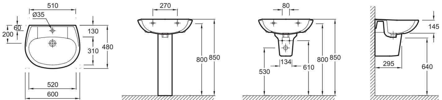
Descriptif CCTP : Lavabo 60 cm, sans trou de trop-plein. E1288. Collection : BRIVE. DIMENSIONS : 60 x 48 cm. POIDS : 13,9 kg. MATÉRIAU : Céramique. TYPE D'INSTALLATION : Autoportant. FIXATIONS : 3 types de fixations possibles : Goujons, consoles ou crochets.
