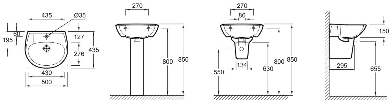
Descriptif CCTP : Lavabo 50 cm. E1345F. Collection : BRIVE. DIMENSIONS : 50 x 43,50 cm. POIDS : 12,5 kg. MATÉRIAU : Céramique. TYPE D'INSTALLATION : Autoportant. FIXATIONS : 3 types de fixations possibles : Goujons, consoles ou crochets. OPTIONS : Colonne, cache-siphon.
