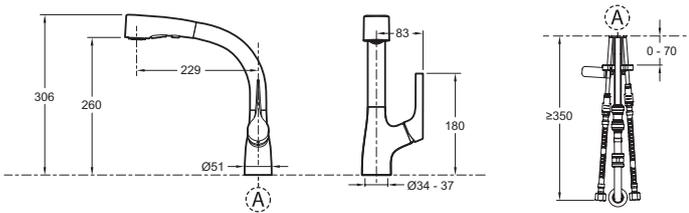
Descriptif CCTP : Mitigeur évier avec flexibles d'alimentation. E13963. Collection : ELATE. POIDS : 3,5 kg. MATÉRIAU : Métal. TYPE D'INSTALLATION : 1 trou. NORMES ET RÉGLEMENTATIONS : ACS : 11 ACC LY 589. TYPE : Mitigeur. DÉBIT (L/MN SOUS 3 BARS) : 6 l/mn. HAUTEUR TOTALE DU ROBINET (MM) : 306. RACCORDS : Avec flexibles d'alimentation. MÉCANISME : Cartouche à disques céramique.
