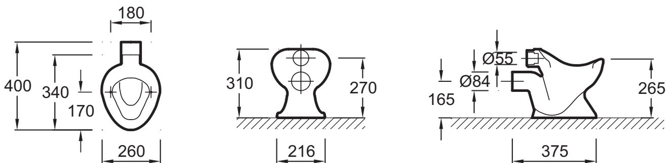
Descriptif CCTP : Cuvette indépendante, sortie horizontale. E1445. Collection : Maternelle. DIMENSIONS : 40 x 26 cm. POIDS : 7,3 kg. MATÉRIAU : Céramique. TYPE D'INSTALLATION : Au sol. TYPE DE BRIDE : Ouverte (traditionnelle). Sortie horizontale.
