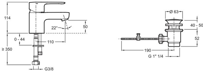
Descriptif CCTP : Mitigeur lavabo. E16027-4. Collection : JULY. POIDS : 1,3 kg. MATÉRIAU : Métal. TYPE D'INSTALLATION : 1 trou. NORMES ET RÉGLEMENTATIONS : NF : I - ECAU : E0 C2 A2 U3 (Ge3) - ACS : 10 ACCLY 113. TYPE : Mitigeur. DÉBIT (L/MN SOUS 3 BARS) : 10 l/mn. RACCORDS : Avec flexibles d'alimentation. MÉCANISME : Cartouche à disques céramique. Bonde de vidage métal-plastique.
