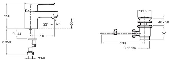
Descriptif CCTP : Mitigeur lavabo avec flexibles d'alimentation. E16027-4D. Collection : JULY. POIDS : 1,5 kg. MATÉRIAU : Métal. TYPE D'INSTALLATION : 1 trou. NORMES ET RÉGLEMENTATIONS : NF : I - ECAU : E0 C2 A2 U3 (Ge3) - ACS : 10 ACCLY 113. TYPE : Mitigeur. DÉBIT (L/MN SOUS 3 BARS) : 10 l/mn. RACCORDS : Avec flexibles d'alimentation. MÉCANISME : Cartouche à disques céramique. Bonde de vidage en métal.
