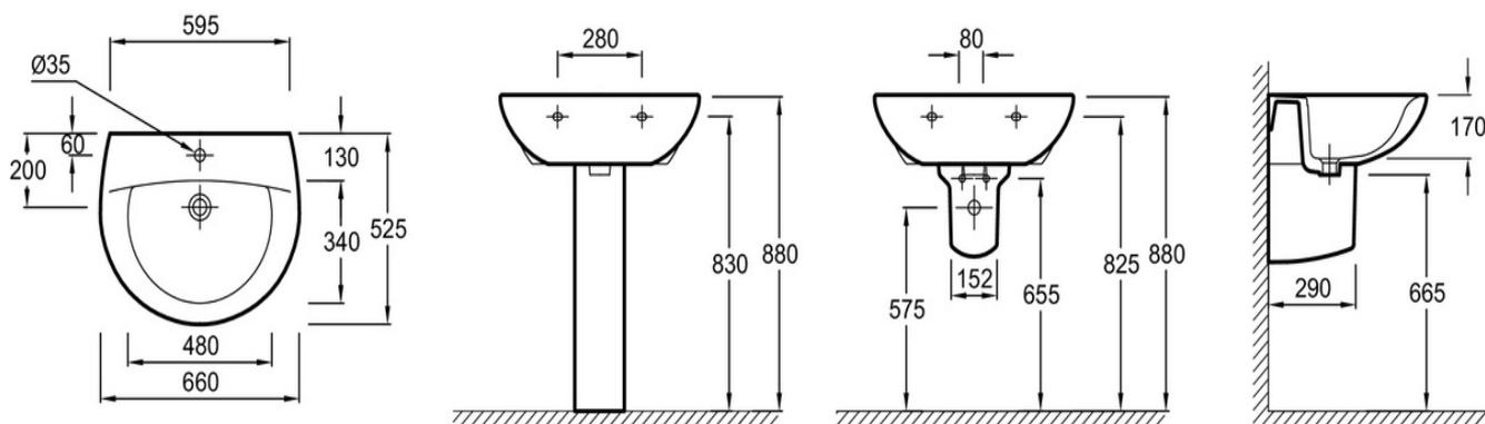
Descriptif CCTP : Lavabo 66 cm. E1998-X5. Collection : PATIO. DIMENSIONS : 66 x 52,50 cm. POIDS : 17,5 kg. MATÉRIAU : Céramique. TYPED'INSTALLATION : Autoportant. CONFIGURATION : STANDARD. SIPHON RECOMMANDÉ : Non. FIXATIONS : Par 2 goujons non fournis. PERCEMENT ROBINETTERIE : 1 trou. TROP-PLEIN : Sans. DURÉE GARANTIE (ANNÉES) : 10.
