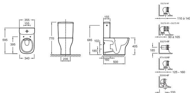
Descriptif CCTP : Pack WC au sol SANS BRIDE, sortie Vario. E20491. Collection : STRUKTURA. DIMENSIONS : 59,50 x 35,50 cm. POIDS : 42 kg. MATÉRIAU : Céramique. TYPE D'INSTALLATION : Au sol. CONSOMMATION D'EAU : Standard 3/6 L. TYPE DE BRIDE : Sans bride.
