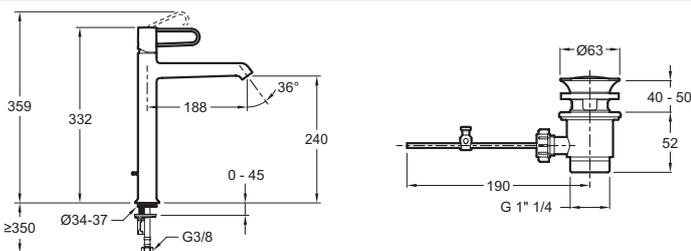
Descriptif CCTP : Mitigeur lavabo - haut - avec vidage. E21030-BL. Collection : ODÉON RIVE GAUCHE. POIDS : 2 kg. MATÉRIAU : Métal. TYPE D'INSTALLATION : 1 trou. TYPE : Mitigeur. DÉBIT (L/MN SOUS 3 BARS) : 5 l/mn. HAUTEUR TOTALE DU ROBINET (MM) : 332. SAILLIE DU BEC (MM) : 188. RACCORDS : Avec flexibles d'alimentation. MÉCANISME : Cartouche à disques céramique.
