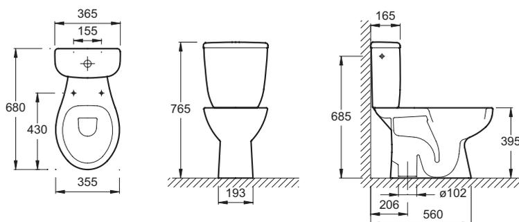
Descriptif CCTP : Cuvette sortie horizontale, sans abattant. E21115MA. Collection : BRIVE. DIMENSIONS : 66 x 35,50 cm. POIDS : 15,6 kg. MATÉRIAU : Céramique. TYPE D'INSTALLATION : Au sol. HAUTEUR : Standard. TYPE DE BRIDE : Ouverte (traditionnelle). Fonctionnement double chasse 3/6 L.
