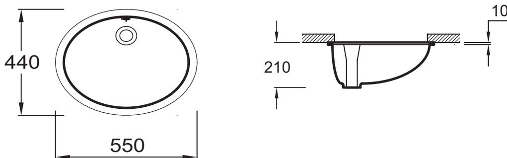
Descriptif CCTP : Vasque à encastrer par-dessous 55 cm. E2211. Collection : CAXTON. DIMENSIONS : 55 x 44 cm. POIDS : 22,9 kg. MATÉRIAU : Céramique. TYPE D'INSTALLATION : Encastré par-dessous.
