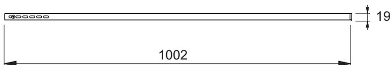
Descriptif CCTP : Barre horizontale fixée à 90°. E22BW90. Collection : CONTRA. DIMENSIONS : x 1,90 cm. POIDS : 1 kg. MATÉRIAU : Aluminium. TYPE D'INSTALLATION : Mural. TYPE D'ACCESSOIRE : Barre de renfort.
