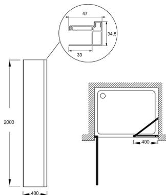
Descriptif CCTP : Paroi extension fixe, en alignement 40 cm. E22L40. Collection : CONTRA. DIMENSIONS : 200 x 40 cm. POIDS : 19 kg. MATÉRIAU : Verre transparent. TYPE D'INSTALLATION : Walk-in. NORMES ET RÉGLEMENTATIONS : EN 14428. LARGEUR MIN/MAX FIXE EN CM : 36 - 38 cm. BARRE DE RENFORT : obligatoire : horizontale ou en diagonale. MONTAGE : Réversible. HAUTEUR DES PAROIS EN CM : 200. ÉTANCHÉITÉ : Fermeture de la porte par joint magnétique, baguette de seuil fournie.
