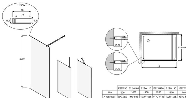
Descriptif CCTP : Paroi fixe 110 cm - verre transparent. E22W110. Collection : CONTRA. DIMENSIONS : 200 x 110 cm. MATÉRIAU : Verre transparent. TYPE D'INSTALLATION : Walk-in. NORMES ET RÉGLEMENTATIONS : EN 14428. LARGEUR MIN/MAX FIXE EN CM : 107 - 108.5. BARRE DE RENFORT : obligatoire : horizontale, verticale ou en diagonale. MONTAGE : Réversible. ÉPAISSEUR DE VERRE EN MM : 8. HAUTEUR DES PAROIS EN CM : 200. DURÉE GARANTIE (ANNÉES) : 2. SÉCURITÉ : Verre transparent de sécurité 8 mm.
