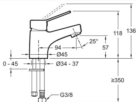
Descriptif CCTP : Mitigeur lavabo. E24158. Collection : ÉO. MATÉRIAU : Métal. TYPE D'INSTALLATION : 1 trou. TYPE : Mitigeur. DÉBIT (L/MN SOUS 3 BARS) : 5 l/mn. HAUTEUR TOTALE DU ROBINET (MM) : 118. SAILLIE DU BEC (MM) : 94. MÉCANISME : Cartouche à disques céramique.
