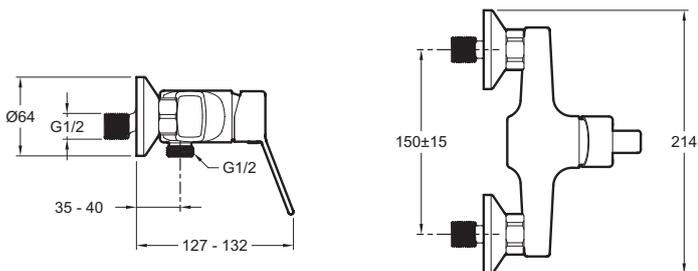
Descriptif CCTP : Mitigeur de douche mural. E24159. Collection : ÉO. MATÉRIAU : Métal. TYPE D'INSTALLATION : 2 trous. TYPE : Mitigeur. DÉBIT (L/MN SOUS 3 BARS) : 13 l/mn. RACCORDS : Avec raccords et rosaces murales. MÉCANISME : Cartouche à disques céramique. TYPE D'INSTALLATION : Mural.
