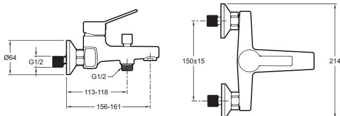
Descriptif CCTP : Mitigeur bain-douche mural. E24160. Collection : ÉO. MATÉRIAU : Métal. TYPE D'INSTALLATION : Mural. TYPE : Mitigeur. DÉBIT (L/MN SOUS 3 BARS) : 12 l/mn /// 17 l/mn. RACCORDS : Avec raccords et rosaces murales. MÉCANISME : Cartouche à disques céramique. ENTRAXE (MM) :  $150 \pm 15$ .
