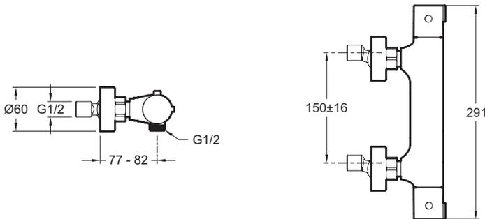
Descriptif CCTP : Mitigeur thermostatique douche mural. E24334. Collection : BRIVE. DIMENSIONS : 10 x 6 cm. POIDS : 1,4 kg. MATÉRIAU : N/A. TYPE D'INSTALLATION : 2 trous. NORMES ET RÉGLEMENTATIONS : NF : E1 C3 A2 U3 // ACS : 19 ACC LY 719. TYPE : Mitigeur. DÉBIT (L/MN SOUS 3 BARS) : 12 l/mn. RACCORDS : Avec raccords et rosaces murales.
