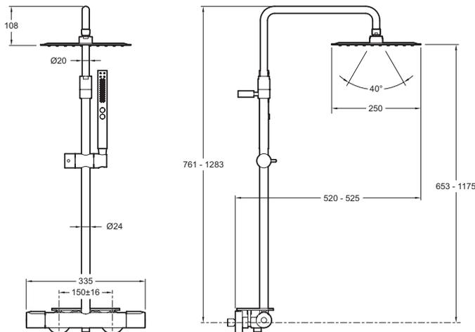
Descriptif CCTP : Colonne de douche thermostatique. E26595. Collection : MÉTRO. MATÉRIAU : Métal. TYPE D'INSTALLATION : Mural. Douche de tête carrée ultrafine 250 x 250 mm. Flexible lisse anti-torsion 1600 mm.
