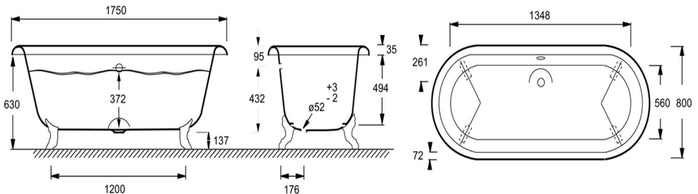
Descriptif CCTP : Baignoire fonte 175 x 80 cm. E29014. Collection : CLÉO. DIMENSIONS : 175 x 80 cm. POIDS : 146,4 kg. MATÉRIAU : Fonte émaillée. TYPE D'INSTALLATION : En îlot. HAUTEUR D'EAU : 37,2 cm. HAUTEUR D'ENJAMBEMENT : 67,5 cm. VOLUME (L) : 271/201. FORME : Ovale. DIAMÈTRE DE BONDE (CM) : 5,2 cm. HAUTEUR DES PIEDS : de 13 à 17 cm. DURÉE GARANTIE (ANNÉES) : 25. INSTALLATION EN ÎLOT : Sur pieds "patte de lion".
