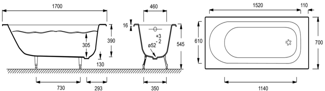
Descriptif CCTP : Baignoire en fonte 170 x 70 cm, anti-dérapant. E2921-F. Collection : SOISSONS. DIMENSIONS : 170 x 70 cm. POIDS : 99,2 kg. MATÉRIAU : Fonte émaillée. TYPE D'INSTALLATION : Encastré. NORMES ET RÉGLEMENTATIONS : NF. HAUTEUR D'EAU : 30,5 cm. HAUTEUR D'ENJAMBEMENT : 54,5 cm. VOLUME (L) : 158/88. FORME : Rectangulaire. DIAMÈTRE DE BONDE (CM) : 5,2. HAUTEUR DES PIEDS : de 14 à 17 cm. DURÉE GARANTIE (ANNÉES) : 25. DIMENSIONS FOND DE CUVE : 114 x 40 cm.
