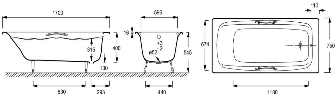
Descriptif CCTP: Baignoire en fonte 170 x 75 cm, percée. E2926. Collection: DIAPASON. DIMENSIONS: 170 x 75 x 40 cm. POIDS: 104,4 kg. MATÉRIAU: Fonte émaillée. TYPE D'INSTALLATION: Encastré. NORMES ET RÉGLEMENTATIONS: NF. HAUTEUR D'EAU: 31,5 cm. HAUTEUR D'ENJAMBEMENT: 54,5 cm. VOLUME (L): 162/92. FORME: Rectangulaire. DIAMÈTRE DE BONDE (CM): 5,2 cm. HAUTEUR DES PIEDS: 13 cm. INFORMATIONS COMPLÉMENTAIRES: Contre un mur. Baignoire percée pour poignées.
