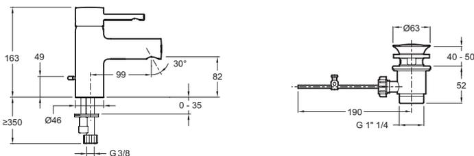
Descriptif CCTP : Mitigeur lavabo - modèle Medium. E37041. Collection : CÜFF. POIDS : 1,4 kg. MATÉRIAU : Métal. TYPE D'INSTALLATION : 1 trou. NORMES ET RÉGLEMENTATIONS : NF : I - ECAU : E00 Ch2 A3 U3 (Ps3) - ACS : 10 ACC LY 113. TYPE : Mitigeur. DÉBIT (L/MN SOUS 3 BARS) : 5 l/mn. HAUTEUR TOTALE DU ROBINET (MM) : 163. SAILLIE DU BEC (MM) : 99. RACCORDS : Avec flexibles d'alimentation. MÉCANISME : Cartouche à disques céramique. VIDAGE : Avec. GARANTIE MÉCANISME : 5 ans. TYPE DE FLEXIBLE : PEX.
