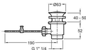
Descriptif CCTP : Mitigeur lavabo - modèle Haut - avec vidage. E37303. Collection : CÜFF. POIDS : 2 kg. MATÉRIAU : Métal. TYPE D'INSTALLATION : 1 trou. NORMES ET RÉGLEMENTATIONS : ACS : 14 ACC LY 113. TYPE : Mitigeur. DÉBIT (L/MN SOUS 3 BARS) : 5 l/mn. HAUTEUR TOTALE DU ROBINET (MM) : 258. SAILLIE DU BEC (MM) : 130. RACCORDS : Avec flexibles d'alimentation. MÉCANISME : Cartouche à disques céramique. VIDAGE : Avec. GARANTIE MÉCANISME : 5 ans. TYPE DE FLEXIBLE : PEX.
