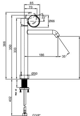
Descriptif CCTP : Mitigeur réhaussé - Bijou Chrome Brossé. E38683-LB1. Collection : VIVIENNE SIGNATURE. DIMENSIONS : 5 x 35 cm. POIDS : 1 kg. MATÉRIAU : Métal. TYPE D'INSTALLATION : 1 trou. TYPE : Mitigeur. DÉBIT (L/MN SOUS 3 BAR) : 5 l/mn. RACCORDS : Avec flexibles d'alimentation.
