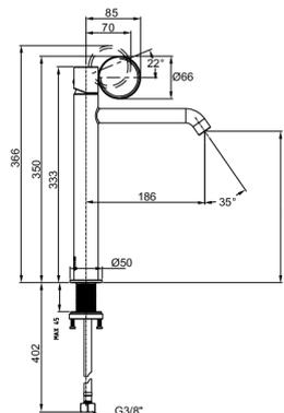
Descriptif CCTP : Mitigeur réhaussé - Bijou Noir Mat. E38683-LB2. Collection : VIVIENNE SIGNATURE. DIMENSIONS : 5 x 35 cm. POIDS : 1 kg. MATÉRIAU : Métal. TYPE D'INSTALLATION : 1 trou. TYPE : Mitigeur. DÉBIT (L/MN SOUS 3 BAR) : 5 l/mn. RACCORDS : Avec flexibles d'alimentation.
