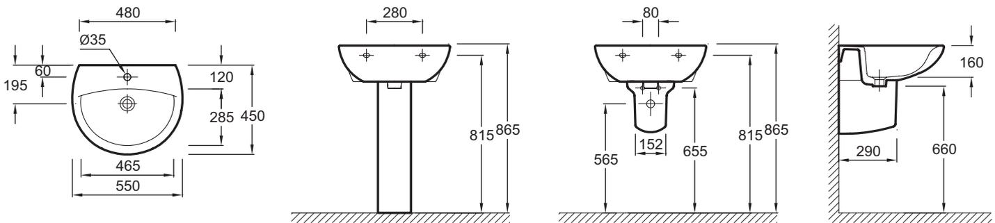
Descriptif CCTP : Lavabo 55 cm. E4158-X5. Collection : PATIO. DIMENSIONS : 55 x 45 cm. POIDS : 12,9 kg. MATÉRIAU : Céramique. TYPE D'INSTALLATION : Autoportant. PERCEMENT ROBINETTERIE : 1 trou. CONFIGURATION : STANDARD. TROP-PLEIN : Sans.
