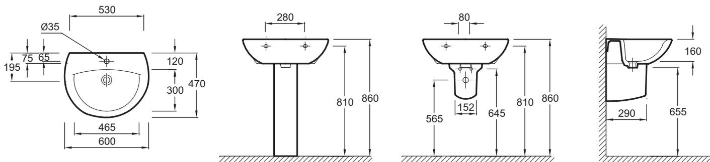
Descriptif CCTP : Lavabo 60 cm. E4159-X5. Collection : PATIO. DIMENSIONS : 60 x 47 cm. POIDS : 13,8 kg. MATÉRIAU : Céramique. TYPE D'INSTALLATION : Autoportant. PERCEMENT ROBINETTERIE : 1 trou. CONFIGURATION : STANDARD. TROP-PLEIN : Sans.
