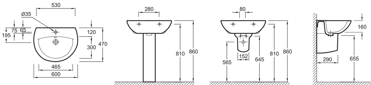
Descriptif CCTP : Lavabo 60 cm. E4159. Collection : PATIO. DIMENSIONS : 60 x 47 cm. POIDS : 13,8 kg. MATÉRIAU : Céramique. TYPE D'INSTALLATION : Autoportant. FIXATIONS : Par 2 goujons non fournis. PERCEMENT ROBINETTERIE : 1 trou. CONFIGURATION : STANDARD.
