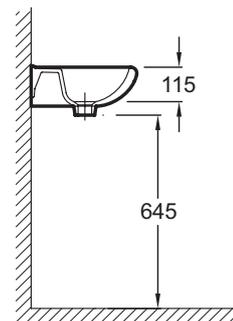
Descriptif CCTP : Lave-mains 45 cm. E4338. Collection : BRIVE. DIMENSIONS : 45 x 35 cm. POIDS : 8,2 kg. MATÉRIAU : Céramique. TYPE D'INSTALLATION : Autoportant. FIXATIONS : Par goujon. PERCEMENT ROBINETTERIE : 1 trou. CONFIGURATION : STANDARD. TROP-PLEIN : Avec.
