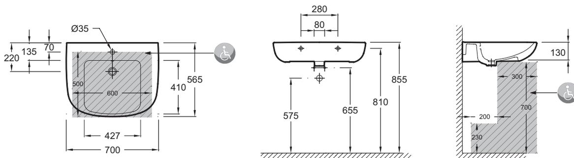
Descriptif CCTP : Lavabo PMR 70 cm. E4495. Collection : ODÉON UP. DIMENSIONS : 70 x 56,50 cm. POIDS : 19,5 kg. MATÉRIAU : Céramique. TYPE D'INSTALLATION : Autoportant. PERCEMENT ROBINETTERIE : 1 trou. CONFIGURATION : STANDARD. TROP-PLEIN : Avec.
