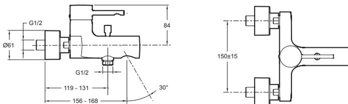
Descriptif CCTP : Mitigeur bain-douche mural. E45532. Collection : CÜFF. POIDS : 2,6 kg. MATÉRIAU : N/A. TYPE D'INSTALLATION : Mural. NORMES ET RÉGLEMENTATIONS : NF : IC/A - ECAU : E3/1 C A2 U3 - ACS : 10 ACC LY 004. TYPE : Mitigeur. DÉBIT (L/MN SOUS 3 BARS) : 20 l/mn. SAILLIE DU BEC (MM) : 156 - 168. RACCORDS : Avec raccords et rosaces murales. MÉCANISME : Cartouche à disques céramique. ENTRAXE (MM) : 150 ± 15. NOUVEAUTÉ : 0.
