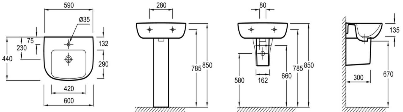
Descriptif CCTP : Lavabo 60 cm. E4700. Collection : ODÉON UP. DIMENSIONS : 60 x 44 cm. POIDS : 15,4 kg. MATÉRIAU : Céramique. TYPE D'INSTALLATION : Autoportant. NORMES ET RÉGLEMENTATIONS : NF ; FDES. CONFIGURATION : COMPACT. PERCEMENT ROBINETTERIE : 1 trou. TROP-PLEIN : Avec.
