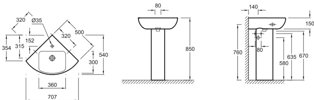
Descriptif CCTP : Lavabo d'angle 50 cm. E4710. Collection : ODÉON UP. DIMENSIONS : 50 x 50 cm. POIDS : 16 kg. MATÉRIAU : Céramique. TYPE D'INSTALLATION : Autoportant ou peut être monté sur un meuble spécifique. PERCEMENT ROBINETTERIE : 1 trou. CONFIGURATION : ANGLE. TROP-PLEIN : Avec. ROBINETTERIE CONSEILLÉE : Aleo, une gamme design très accessible.
