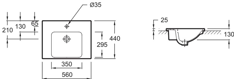
Descriptif CCTP : Vasque à encastrer par-dessus 56 cm. E4756. Collection : ODÉON UP. DIMENSIONS : 56 x 44 cm. POIDS : 12,5 kg. MATÉRIAU : Céramique. TYPE D'INSTALLATION : Encastré par-dessus. PERCEMENT ROBINETTERIE : 1 trou. ROBINETTERIE CONSEILLÉE : Aleo, une gamme design très accessible.
