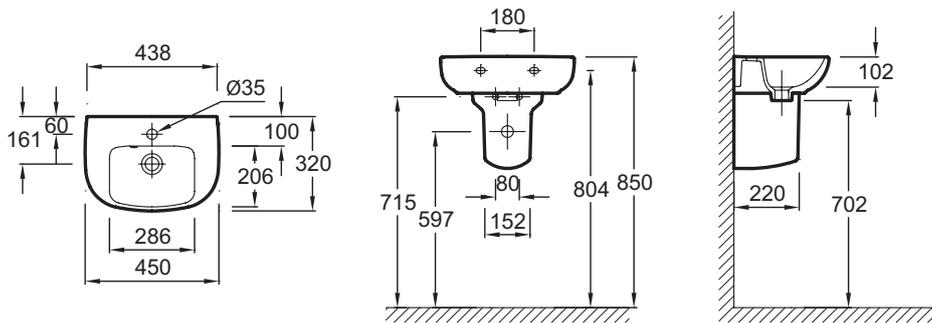
Descriptif CCTP : Lave-mains 45 cm. E4760. Collection : ODÉON UP. DIMENSIONS : 45 x 32 cm. POIDS : 8,5 kg. MATÉRIAU : Céramique. TYPE D'INSTALLATION : Autoportant ou peut être monté sur un meuble spécifique. PERCEMENT ROBINETTERIE : 1 trou. CONFIGURATION : STANDARD. TROP-PLEIN : Avec. ROBINETTERIE CONSEILLÉE : Aleo, une gamme design très accessible.
