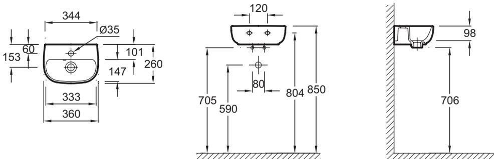
Descriptif CCTP : Lave-mains 36 cm. E4761. Collection : ODÉON UP. DIMENSIONS : 36 x 26 cm. POIDS : 6,5 kg. MATÉRIAU : Céramique. TYPE D'INSTALLATION : Autoportant. PERCEMENT ROBINETTERIE : 1 trou. CONFIGURATION : COMPACT. TROP-PLEIN : Avec. ROBINETTERIE CONSEILLÉE : Aleo, une gamme design très accessible.
