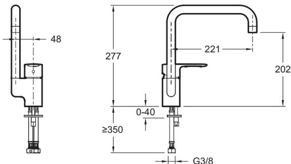
Descriptif CCTP : Mitigeur évier, bec tube. E5243. Collection : JULY. POIDS : 1,4 kg. MATÉRIAU : Métal. TYPE D'INSTALLATION : 1 trou. NORMES ET RÉGLEMENTATIONS : NF : I - ECAU : E0 C2 A2 U3 (Ge3) - ACS : 11 ACCLY 540. TYPE : Mitigeur. DÉBIT (L/MN SOUS 3 BARS) : 10 l/mn. RACCORDS : Avec flexibles d'alimentation. MÉCANISME : Cartouche à disques céramique. Bec tube orientable.
