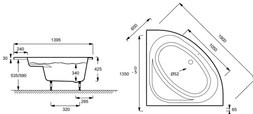
Descriptif CCTP : Baignoire en acrylique 135 x 135 cm. E60223. Collection : BASTILLE. DIMENSIONS : 135 x 135 x 42,50 cm. POIDS : 21,5 kg. MATÉRIAU : Acrylique. TYPE D'INSTALLATION : En angle. HAUTEUR D'EAU : 34 cm. HAUTEUR D'ENJAMBEMENT : De 56,5 à 61 cm. VOLUME (L) : 230/160. FORME : Angle. DIAMÈTRE DE BONDE (CM) : 5,2 cm. HAUTEUR DES PIEDS : de 12 à 17,5 cm. DURÉE GARANTIE (ANNÉES) : 10.
