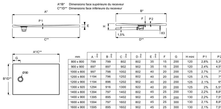
Descriptif CCTP : Receveur 120 x 90 cm. E62105. Collection : AEROBLOC. DIMENSIONS : 120 x 90 x 3,80 cm. POIDS : 15 kg. MATÉRIAU : Aerobloc. ANTIDÉRAPANT : Non. FORME : Rectangulaire. DIAMÈTRE DE BONDE (CM) : 9. DURÉE GARANTIE (ANNÉES) : 10. MATÉRIAU AEROBLOC : sandwich très solide et léger composé de fibres de verre, de résine et de PET recyclé.
