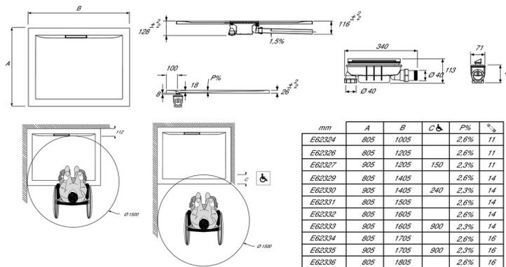
Descriptif CCTP : Receveur 150 x 80 cm - antidérapant. E62331-F. Collection : FLIGHT PURE. DIMENSIONS : 150 x 80 x 2,60 cm. POIDS : 35 kg. MATÉRIAU : Flight. NORMES ET RÉGLEMENTATIONS : CE. ANTIDÉRAPANT : Oui. FORME : Rectangulaire. DURÉE GARANTIE (ANNÉES) : 10. En option : Kit de réhausse (hauteur +10/13 cm).
