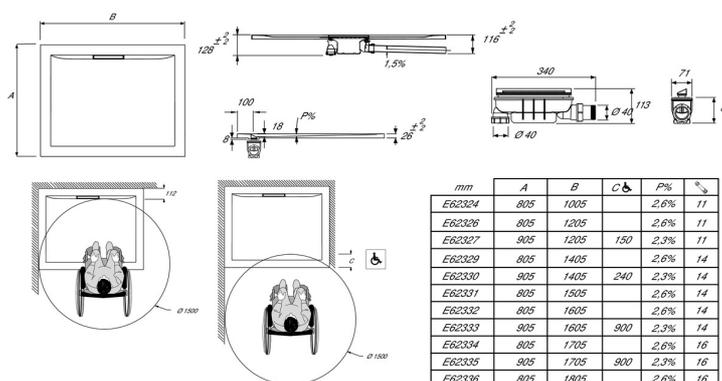
Descriptif CCTP : Receveur 170 x 90 cm. E62335. Collection : FLIGHT PURE. DIMENSIONS : 170 x 90 x 2,60 cm. POIDS : 46 kg. MATÉRIAU : Flight. NORMES ET RÉGLEMENTATIONS : CE. ANTIDÉRAPANT : Non. FORME : Rectangulaire. DURÉE GARANTIE (ANNÉES) : 10. En option : Kit de réhausse (hauteur +10/13 cm).
