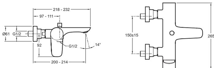
Descriptif CCTP : Mitigeur bain-douche mural. E72282. Collection : ALEO. POIDS : 2,3 kg. MATÉRIAU : Métal. TYPE D'INSTALLATION : 2 trous. NORMES ET RÉGLEMENTATIONS : NF : IC/B - ECAU : E3/1 C2 A2 U3 (Ge3) - ACS : 10ACCLY113. TYPE : Mitigeur. DÉBIT (L/MN SOUS 3 BARS) : 20 l/mn. RACCORDS : Avec raccords et rosaces murales. MÉCANISME : Cartouche à disques céramique. ENTRAXE (MM) : 150 ± 15. NOUVEAUTÉ : 0.
