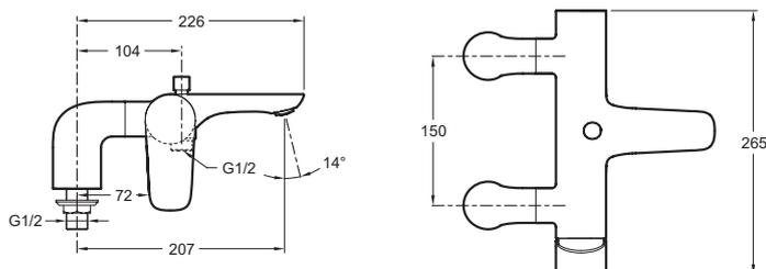
Descriptif CCTP : Mitigeur bain-douche sur gorge. E72283. Collection : ALEO. POIDS : 3 kg. MATÉRIAU : Métal. TYPE D'INSTALLATION : 2 trous. NORMES ET RÉGLEMENTATIONS : NF : IC/B - ECAU : E3/1 C2 A2 U3 (Ge3) - ACS : 10ACCLY113. TYPE : Mitigeur. DÉBIT (L/MN SOUS 3 BARS) : 20 l/mn. RACCORDS : Avec raccords colonnettes. MÉCANISME : Cartouche à disques céramique. ENTRAXE (MM) : 150. NOUVEAUTÉ : 0.
