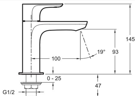
Descriptif CCTP : Robinet indépendant pour lave-mains (eau froide). E72288. Collection : ALEO. POIDS : 0,8 kg. MATÉRIAU : N/A. NORMES ET RÉGLEMENTATIONS : ACS : 15 ACC LY 081. TYPE : Robinet indépendant. DÉBIT (L/MN SOUS 3 BARS) : 5 l/mn. HAUTEUR TOTALE DU ROBINET (MM) : 145. SAILLIE DU BEC (MM) : 100. MÉCANISME : Têtes à disques céramique. VIDAGE : Sans vidage. Passage pour une seule eau.
